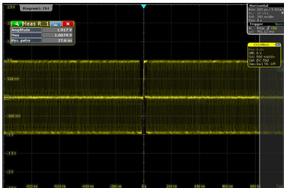
图 10 DUT 被诱导返回的扰码波形
