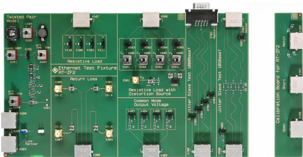
图 7 R&S RT-ZF2 以太网一致性测试夹具
