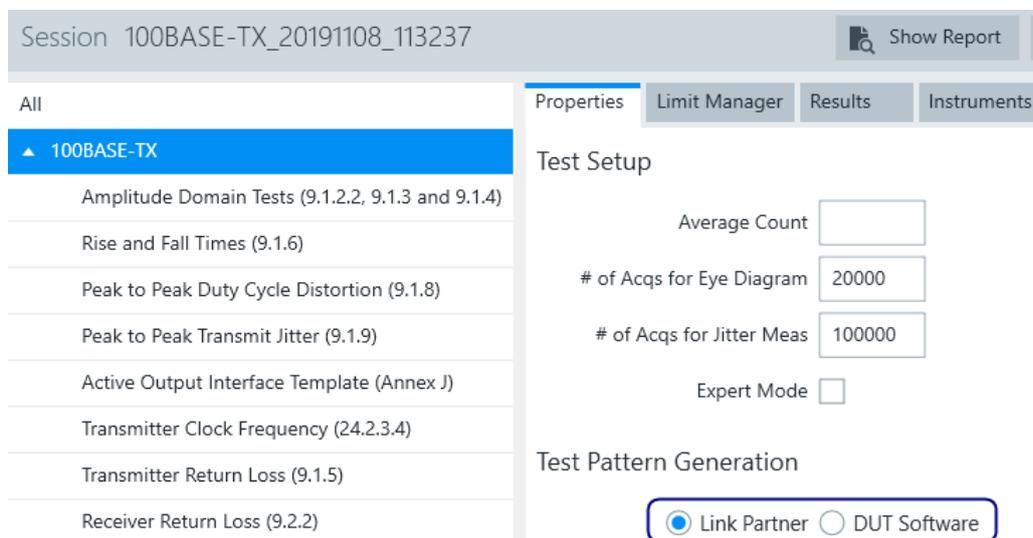
图 11 测试码型产生方式设置
