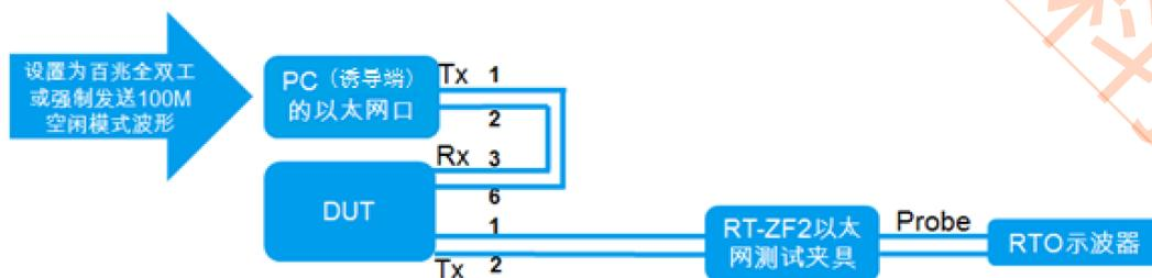
图 8、百兆以太网诱导发包连接设置图
