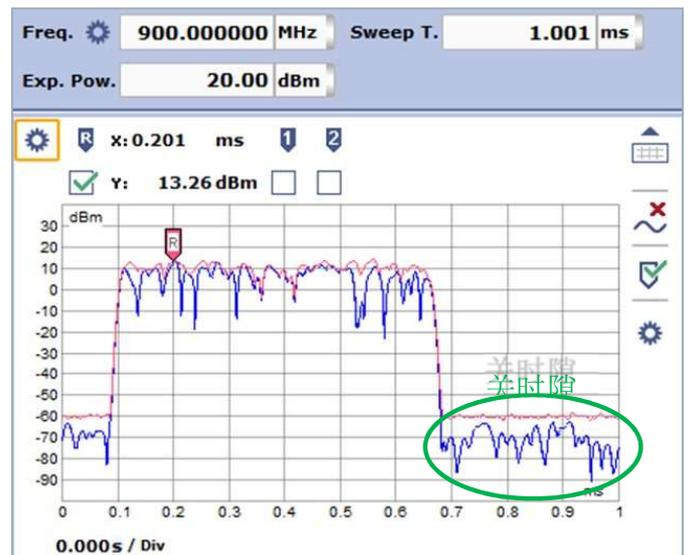
图21 CMA180测量关时隙功率
