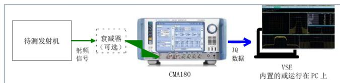
图9 CMA180发射机测试基本连接框图
