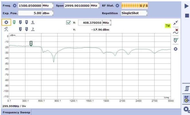
图32 CMA180测试天线反射
