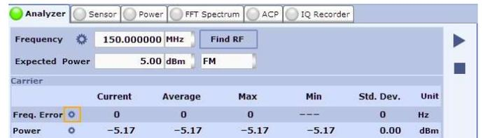
图14 CMA180测量载波频率误差
