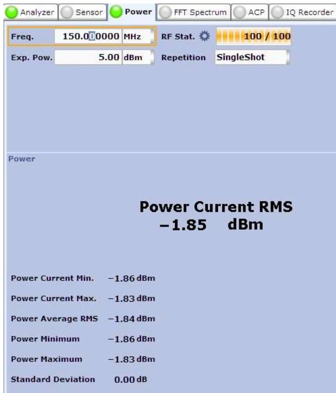
图11 R&S®CMA180测量输入功率 (RF Power) 和功率统计
