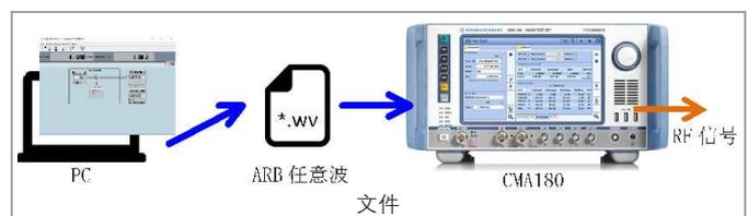
图4 CMA180利用WinIQSim2软件发生数字调制信号
