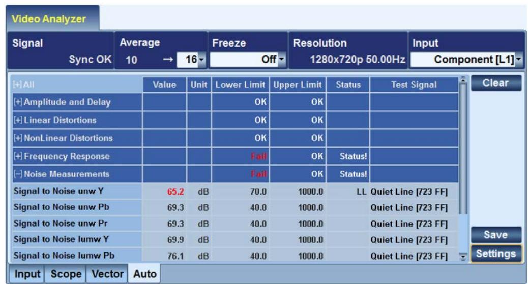
Fig. 3-10: 视频信号的测量设置和测量结果
