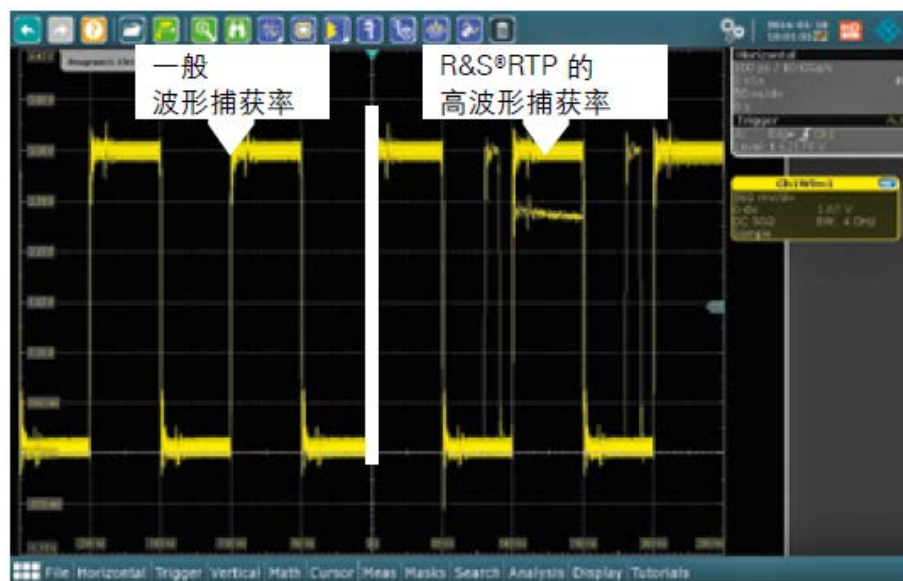
高波形捕获率可以快速检测偶发性信号故障
