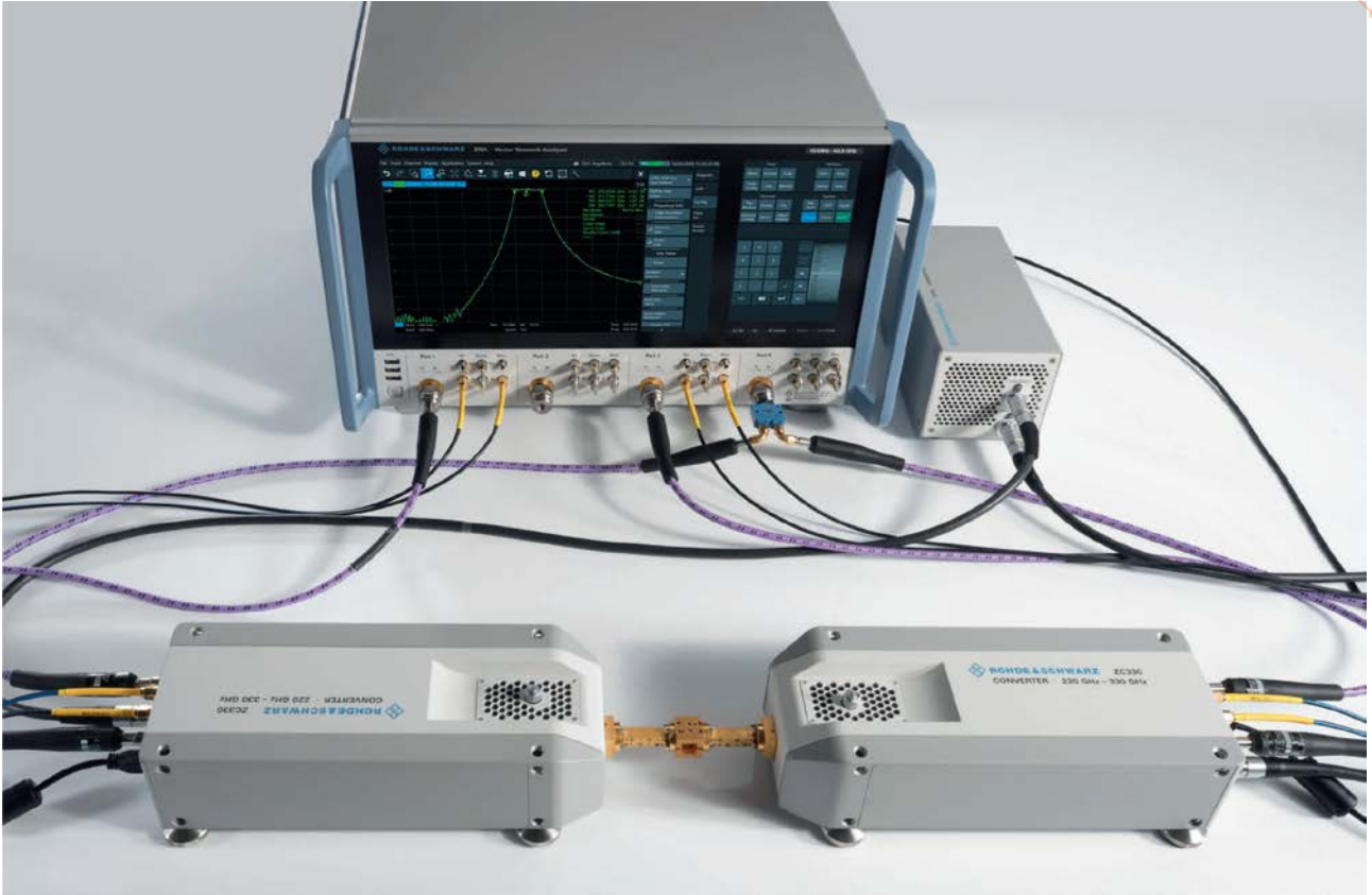
用 R&S®ZNA43 和两个 R&S®ZC330 毫米波扩频器 WM-864 进行毫米波测量的设置状态
