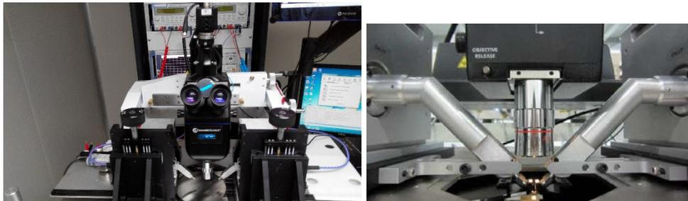
**图5 在片负载牵引测量系统**
