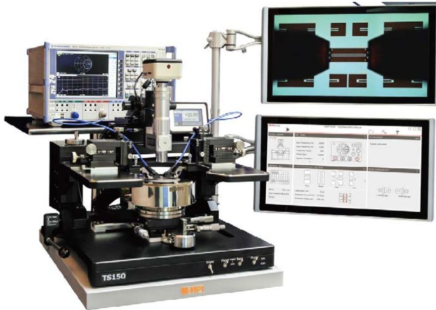
图1 典型的在片S参数测量系统
