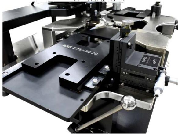
图4 适用于频率扩展模块的微定位器
