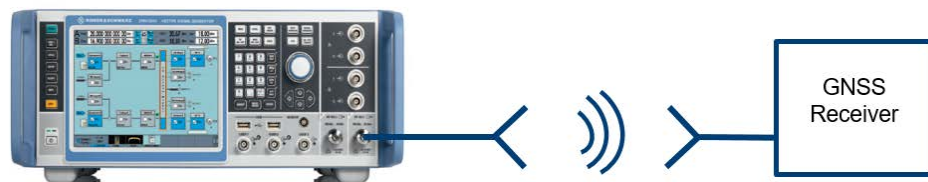
图 11 导航接收机天线口辐射测试
