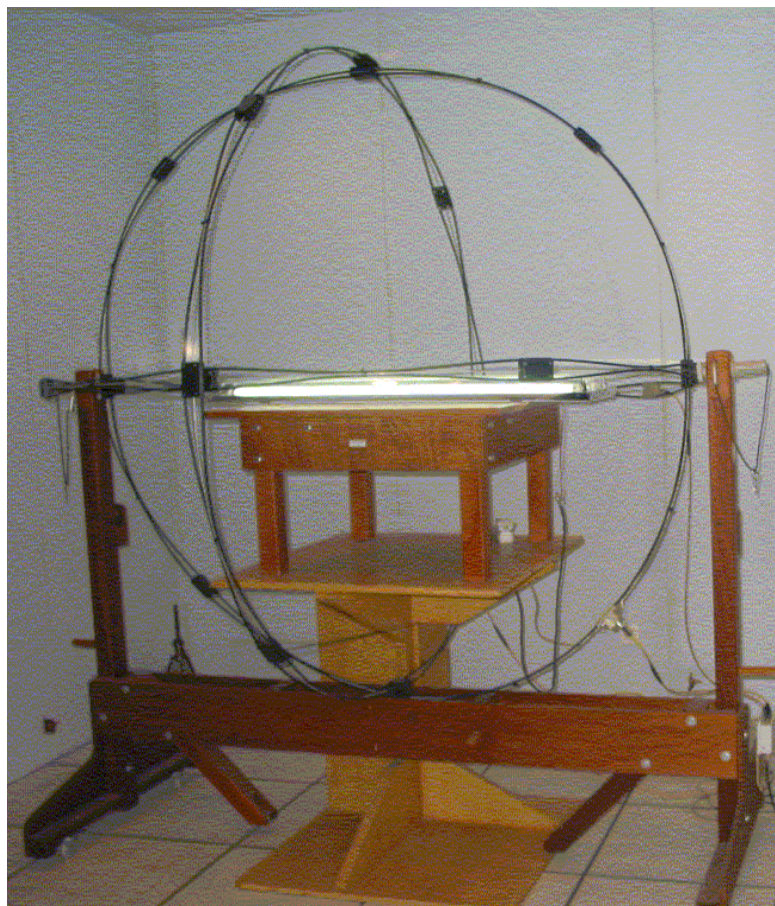
图一：灯具类设备的磁场辐射发射测试
