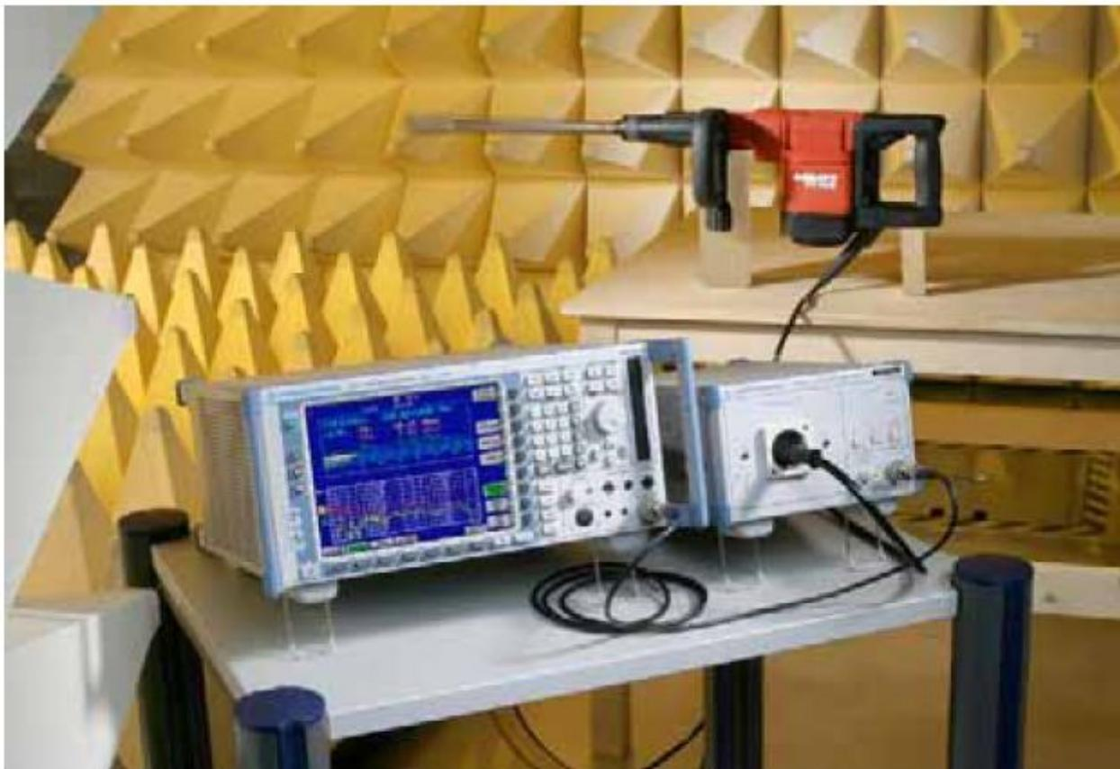
图一：电动工具设备的 EMC 测试现场
