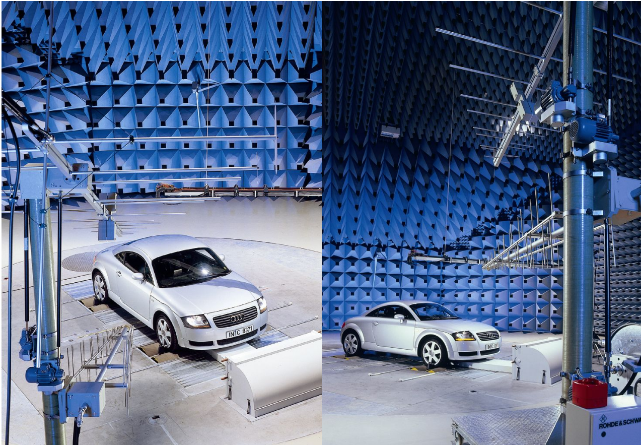
图一：整车的辐射发射测试现场
