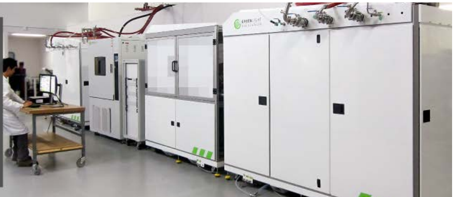
AMETEK AMREL PLW 系列水冷电子负载在 Greenlight 系统中的应用
