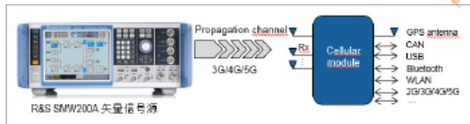
图46 蜂窝通信设备接收机测试框图
