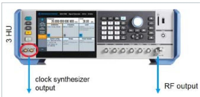
要实现高采样率以及高ENOB，需要宽带噪声极低的信号源。宽带噪声极低的时钟信号不会使ADC采样输入信号的信噪比SNR下降。R&S®SMA100B采用优化的RF设计以及全新的全数字化电平控制回路，在10 GHz载波频率下宽带噪声通常为-160 dBc/Hz。
