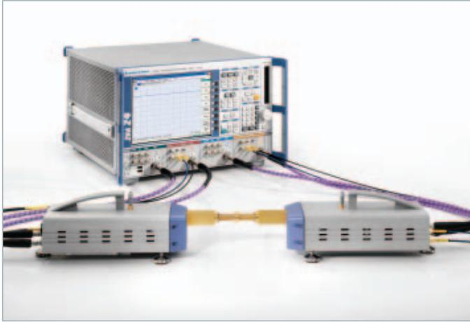
图3 ZVA毫米波频段测试示意图
