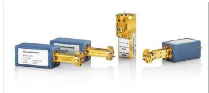
FS-Z90下变频器，工作频段60-90GHz，使用来自FSW的本振信号，进行六倍频以及混频，并将中频信号回传至FSW。对FSW的频段要求较低，FSW26即可使用。结构上是外置单元，可以方便地与测试天线后端相连，并固定于夹具上。
