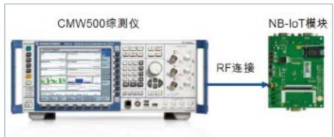
使用R&S®CMW 500平台可以快速的一键测量多个NB-IoT和eMTC发射机测试项目。
