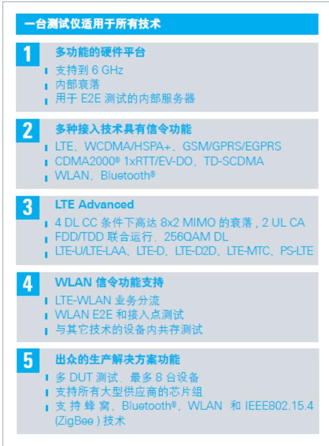
R&S®CMW宽带无线通信测试仪可为所有现代蜂窝和非蜂窝标准提供通用的高效测试解决方案。R&S®CMW是全球使用最广泛的研发、生产和服务的测试与测量平台。它符合先进无线通信测试仪的所有要求。R&S®CMW还可模拟真实条件下的网络运行，以便用于协议和射频测试。
