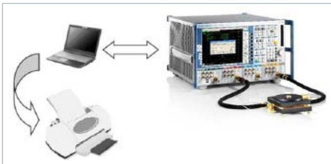
图1 谐振腔法测量系统
