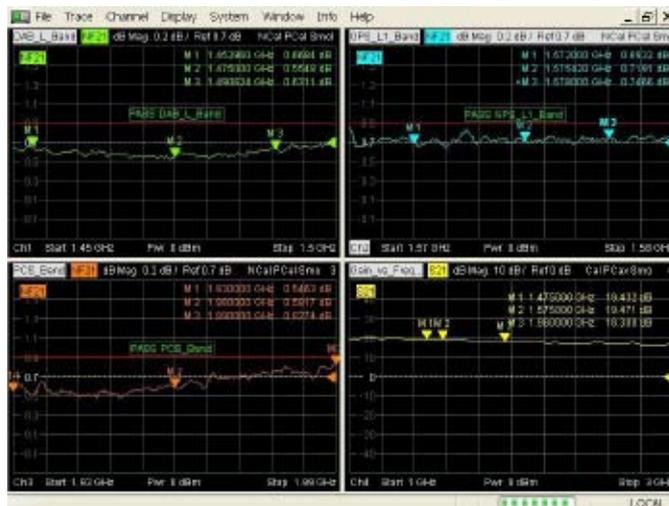
图5 ZVA噪声系数的测试结果
