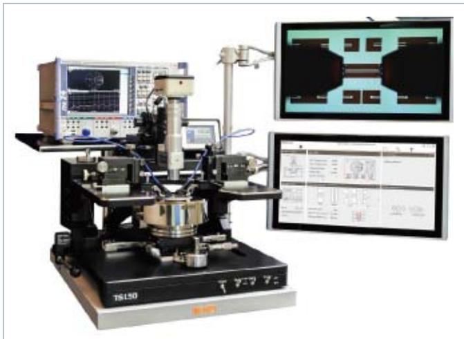
图1 典型的在片S参数测量系统
