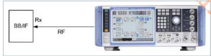
图3 SMW200A实现BBIC接收测试
