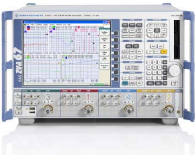
R&S®ZVA系列矢量网络分析仪是要求高性能、多用途的有源、无源器件和模块测量的理想选择，单台仪表可覆盖10 MHz-67 GHz频率范围，也可通过与R&S®ZVA-Zxx系列的
