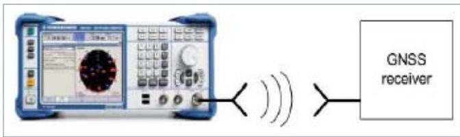
图11 导航接收机天线口辐射测试
