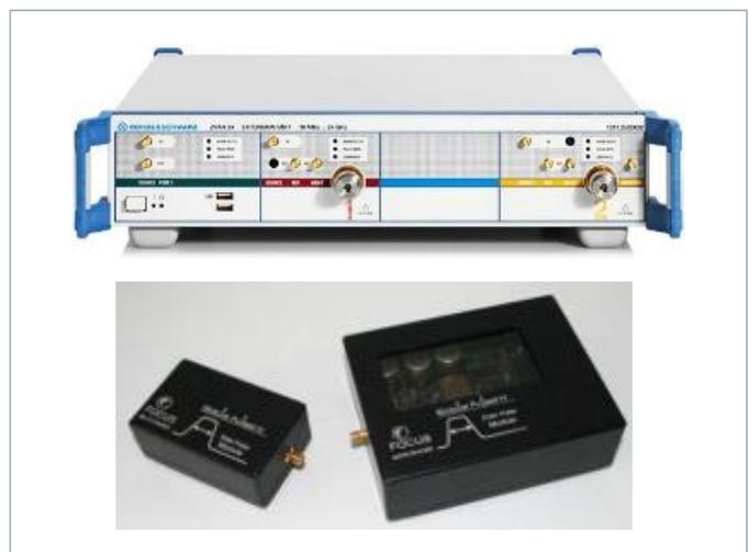
图4 脉冲负载牵引测量系统所需附件
