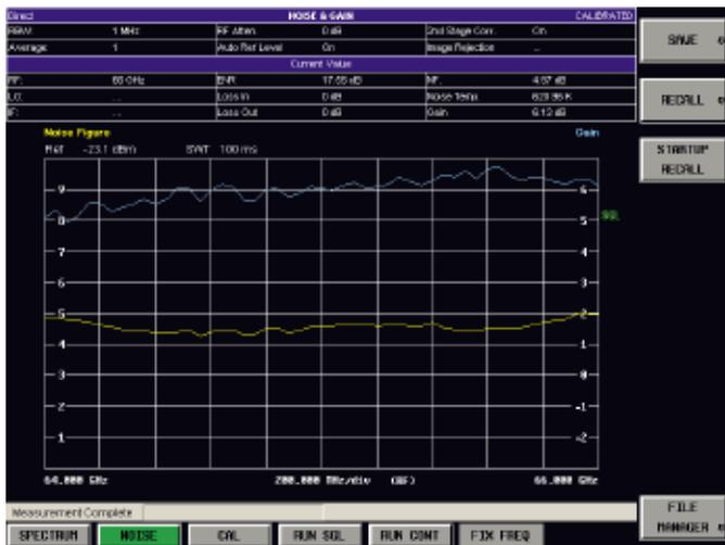
图9 FSW67的60 GHz噪声系数界面
