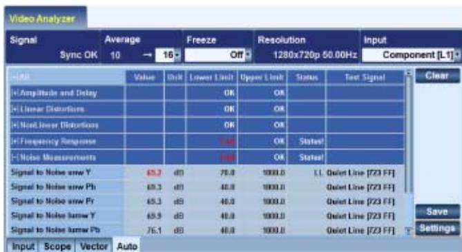
图3-3: 音视频信号的测量设置和测量结果
