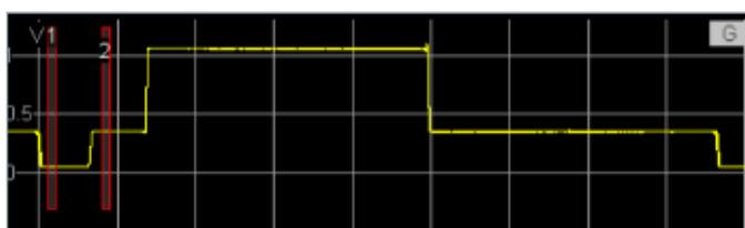
图3-6: RGB信号的同步脉冲测量
