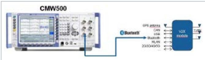
图65 车内Bluetooth无线连接测试框图
