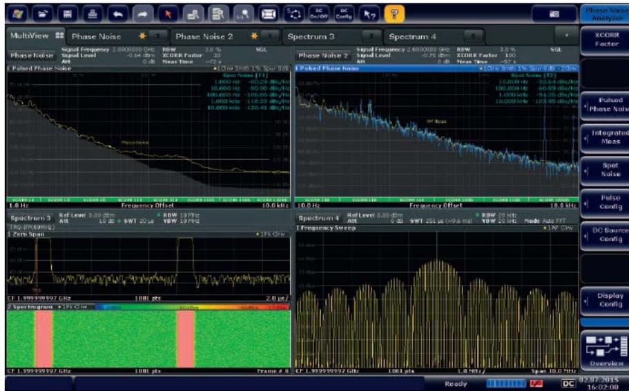
FSWP 可一键测量相位噪声，甚至可测量脉冲源的相位噪声。如加配一个内部源，则此测试仪还可测试单个组件的附加相位噪声。以往，只有使用外部源、功分器和移相器的昂贵且复杂的系统才具备此功能。
