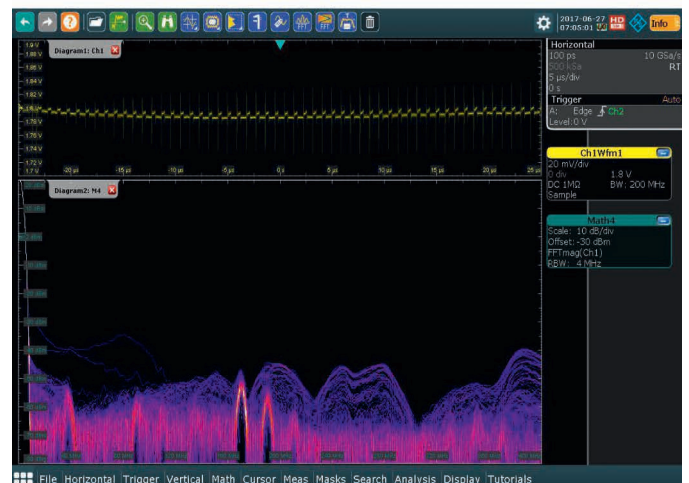
示波器使用近场探头捕获到的辐射源。
