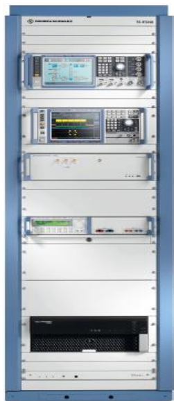
图39 DSRC/IEEE 802.11p一致性测试系统
