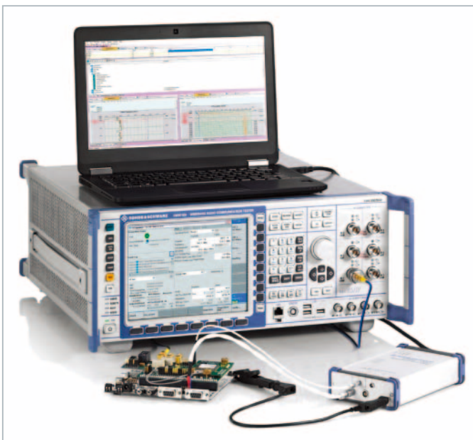
基于R&S®CMW500、R&S®RT-ZVC04多通道功率探头以及R&S®CMWrun自动化测试软件的电池寿命测试解决方案。
