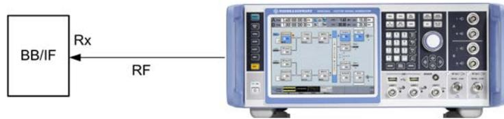
图 24 SMW200A 实现 BBIC 接收测试
