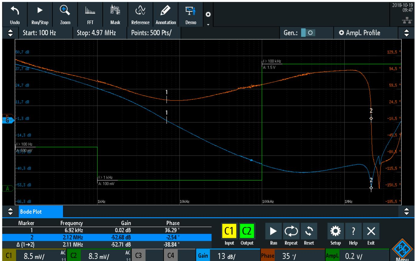
R&S®RTA-K36 频率响应分析（波特图）选件可以测定多种电子设备的频率响应，包括无源滤波器和放大器电路
