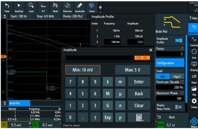
用户可以在测量过程中改变发生器信号的幅度输出电平，以抑制被测设备的噪声特性
