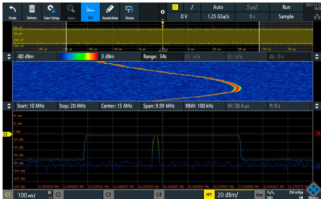
从三个角度测试信号：时域（顶部）、频谱图（中间）和频域（底部）
