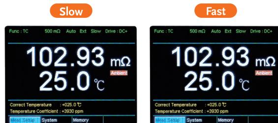
GOM-804/805 提供了 2 种测量速度-快速:可达每秒 60 个读值/慢速:每秒 10 个读值。不同于以往,用户必须在速度和显示分辨率间进行取舍,在 GOM-804/805 上,不管选择的速度为何,都会维持最高的分辨率;即读值分辨率不会因为速度的改变,而造成分辨率下降的情况。
