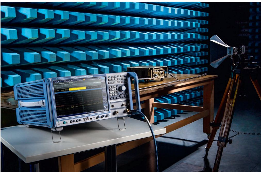
在电波暗室中进行 EMI 测试。
