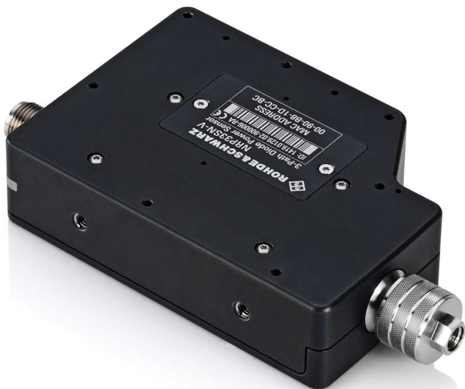
适用于TVAC的 R&S®NRP33SN-V功率 探头
