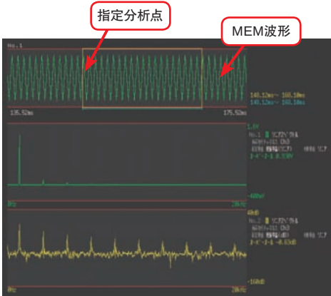
同时显示运算源(MEMORY波形)和FFT运算结果
