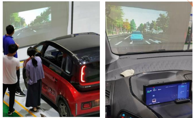
图中显示罗德与施瓦茨和中汽研工程院成功采用此软件模拟摄像头感知的可视化交通场景。
